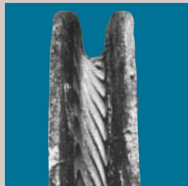
■ En esta polea ordinaria se produjo un deterioro muy severo causando un desgaste rápido al cable de acero y paros costosos.
