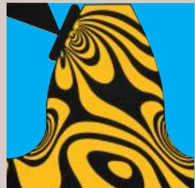
■ El patrón típico de esfuerzo o fatiga de compresión en los dientes de engranes está en el punto de carga, y el esfuerzo de flexión en el radio del fondo ó raíz. Es por eso que la uniformidad de endurecido en la superficie y raíz de los engranes TSP es tan significativa.
