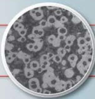
显微照片显示出普通铸铁制动轮容易开裂的结构
