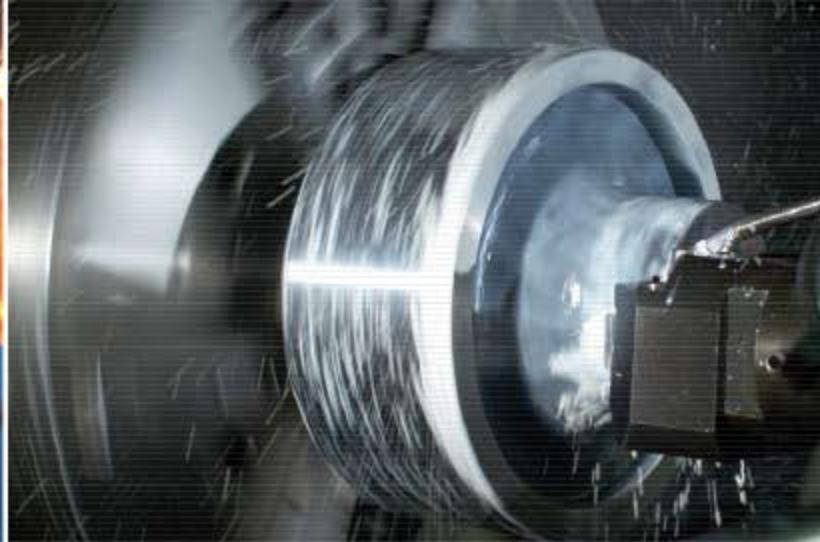
制动轮在完整的制作过程中
