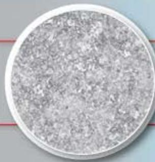
从Xtek锻造钢制动轮的微观结构, 我们可以看到阻止车轮开裂的致密马氏体基体。
