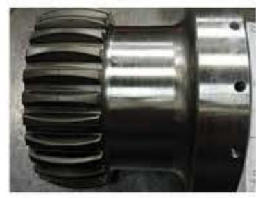
花键连接适配器和轮毂齿轮在进行最终检验。
