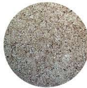
显微金相组织 (100倍)，经过TSP热处理后均匀渗透后的金相组织
