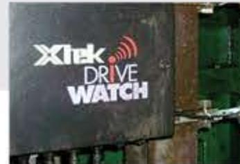
Xtek 实时现场监控沟通服务器靠近热轧带钢轧机精轧机架。该通讯装置已收集齿式接轴的扭矩、温度和振动数据有近十年历史。
