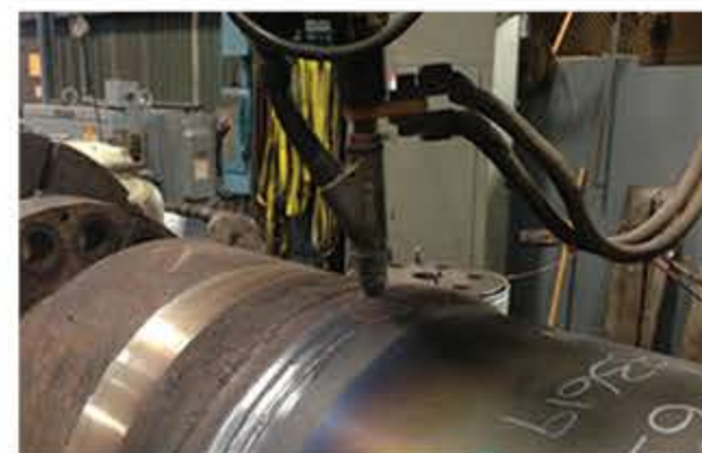
埋弧焊接 (SAW) 过程中的鼓形齿接轴转接器和主轴焊接装配在许多情况下翻新齿式接轴组件需要更换元器件加入到修改的组件中。所有Xtek的焊接过程都得到严格控制，并利用优异的焊丝和焊剂的组合，以产生所需的金属力学性能。
