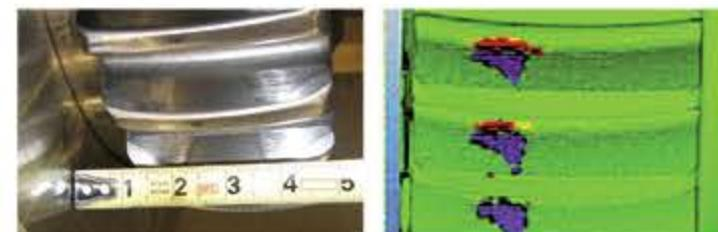
左边图片是运行了12小时后下线评估的产品，图上显示的光亮区域是齿轮啮合部位。下面右边的屏幕截图，是完全相同的齿毂上的部分进行了有限元分析后的实体模型。在相同的角度，施加力的条件下与实际应用情况相符，从而验证了分析的准确度。
