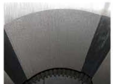
TSP工艺热处理的辊端轴套，其加工面遵循电火花加工(EDM)工艺
