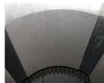
TSP工艺热处理的辊端轴套，其加工面遵循电火花加工 (EDM) 工艺
