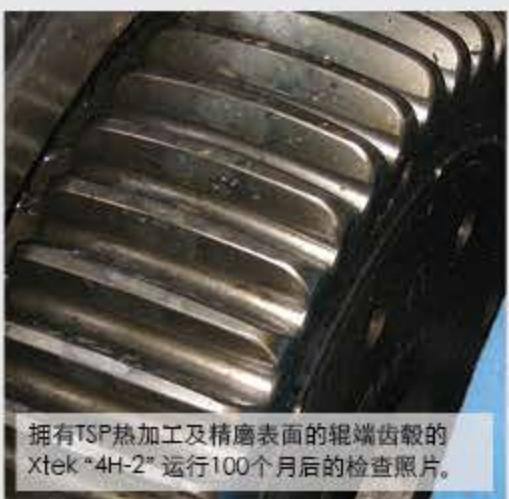
拥有TSP热加工及精磨表面的辊端齿轮的
