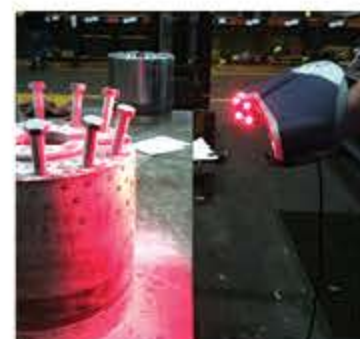
在三维激光扫描过程中的辊端轴套。激光扫描仪上检验到的成品零件尺寸，用于生成复杂的零件实体模型，并为高精度和准确性的工程分析提供依据。
