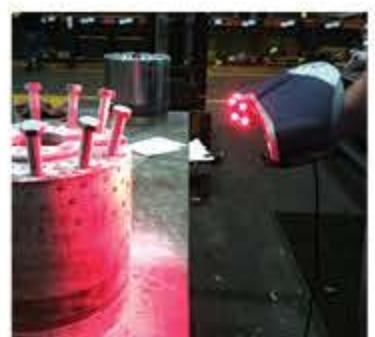
在三维激光扫描过程中的辊端轴套。激光扫描仪上检验到的成品零件尺寸，用于生成复杂的零件实体模型，并为高精密度和准确性的工程分析提供依据。
